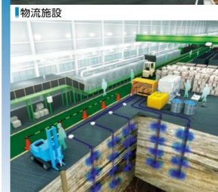
■ 土壌・地下水浄化(原位置浄化技術)
